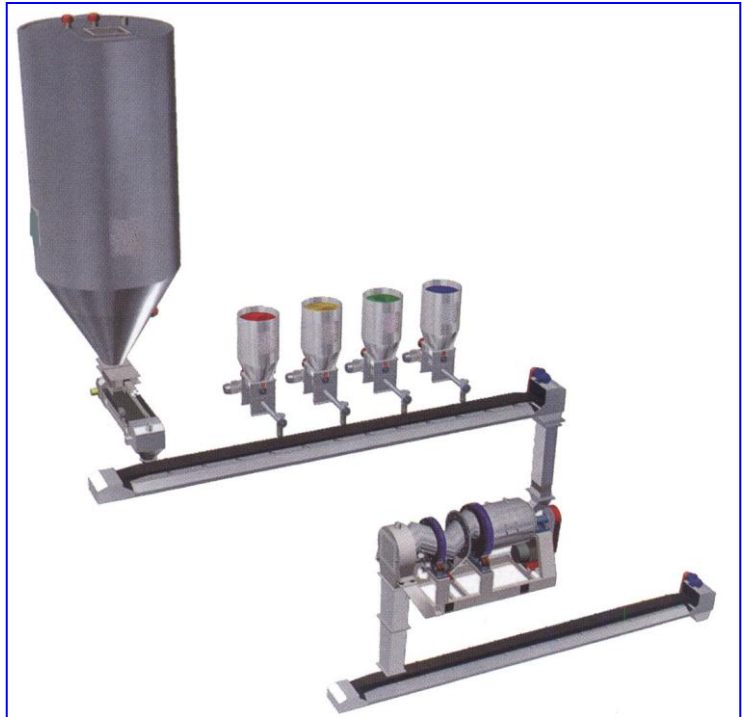
Fig. K.1: schema di apparato per trattamento di polveri (colorazione a secco)
