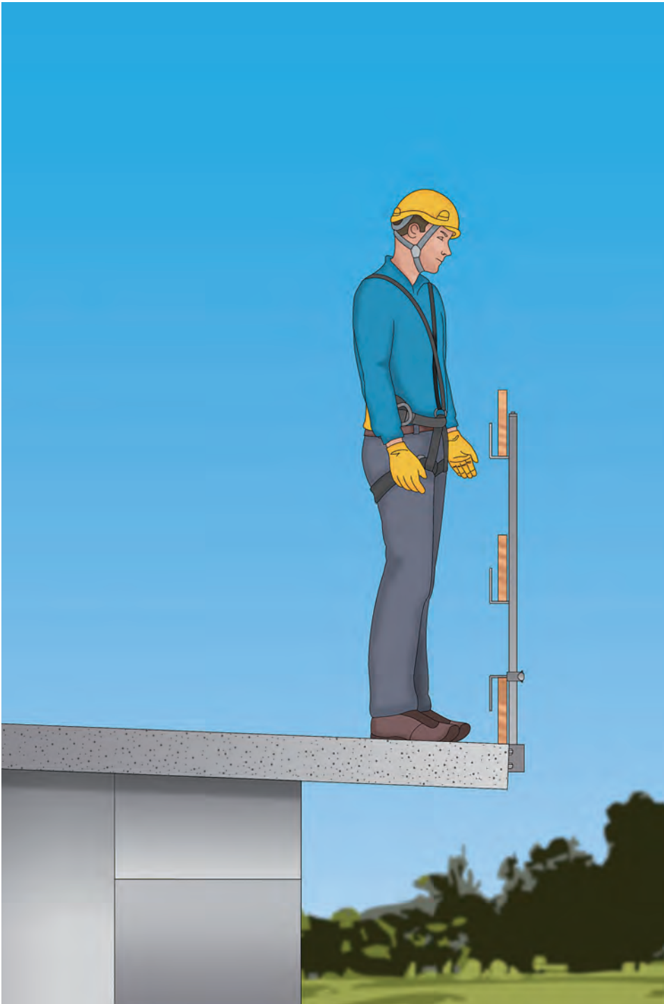
Figura 4 - Parapetti provvisori divisi per classi di utilizzo
