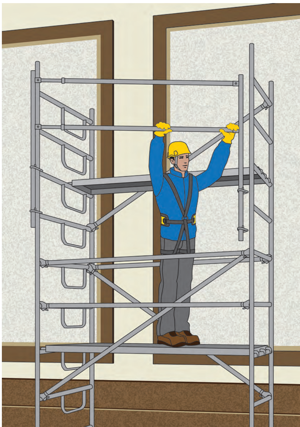
Figura 4 - Trabattello con montaggio dal basso
