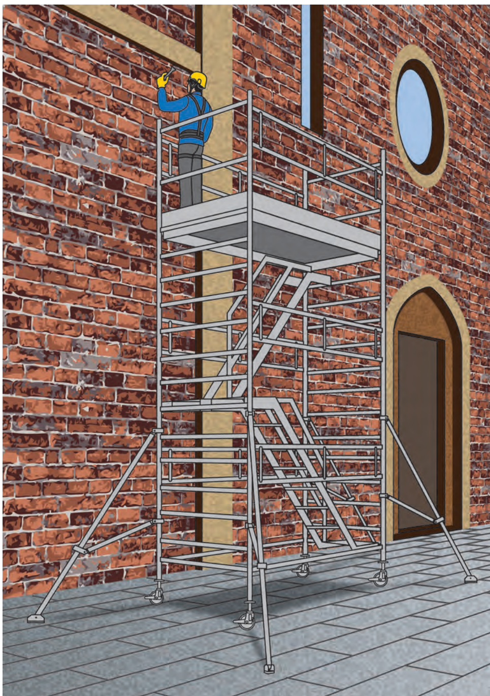
Figura 1 - Trabattello con scala a gradini
