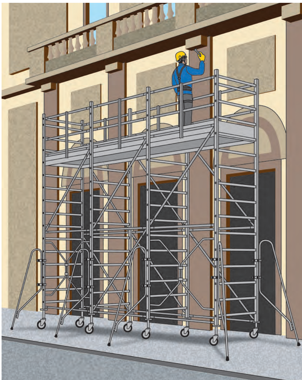
Figura 5 - Utilizzo di un trabattello multiplo (se previsto dal fabbricante)
